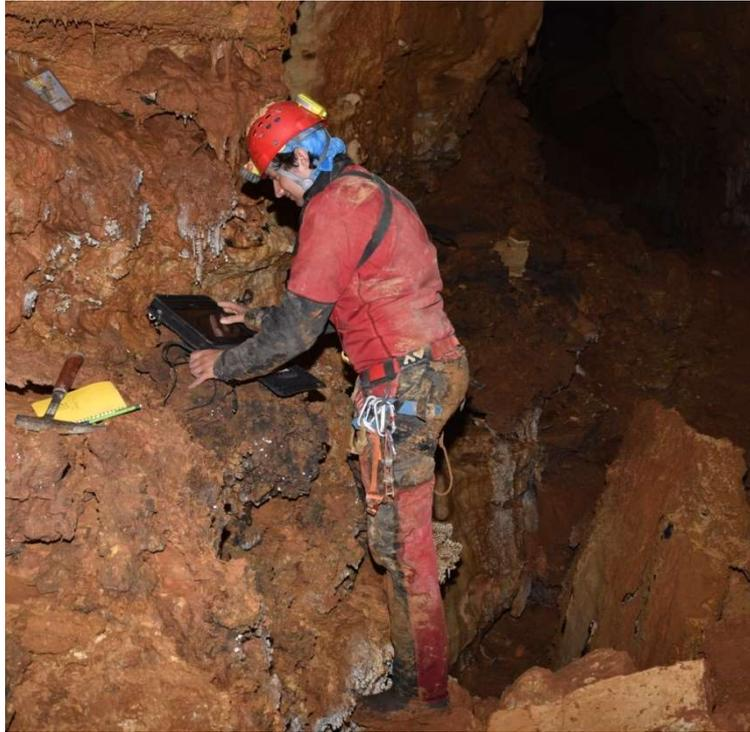
*Paramétrage d'une sonde d'enregistrement de température (photo : D. Lamotte)*
