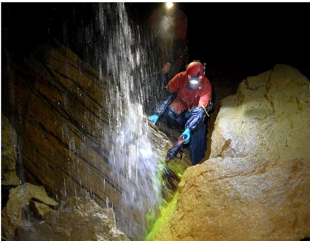
*Injection de la fluorescéine dans les blocs sous la cascade (vidéo : D. Lamotte)*
